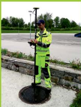
Lage- und Höhen- erfassung von Deckeln und Schächten
