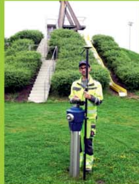
Vermessung von Hydranten
